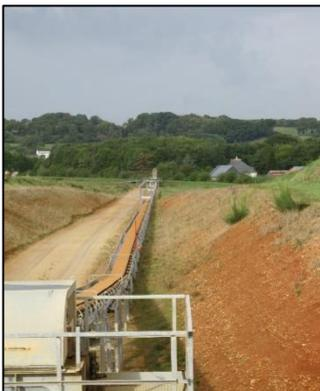
Les matériaux extraits seront égouttés si nécessaire et seront acheminés par une bande transporteuse jusqu'à l'installation de traitement, présente au Nord-Est du site.
